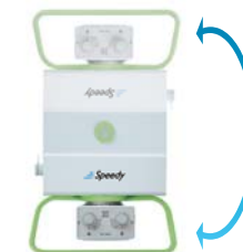
Rotazione frontale del monoblocco \pm 180^\circ Monoblock front rotation \pm 180^\circ
